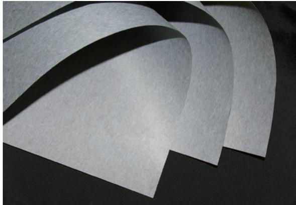
導電性カーボンファイバーを和紙の混紗技術を用いてシート化した高機能材料です。材料特性としては、
